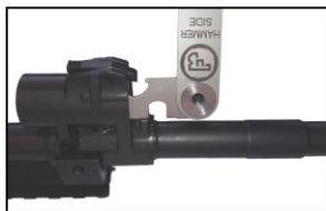
Exemple de l'utilisation d'un grattoir
