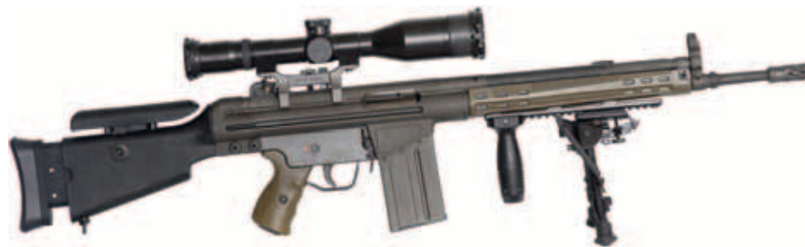
Abb. 1: G3A3ZF-DMR mit ZF Schmidt & Bender 3-12 x 50 PMII-DMR und Wabenfilter. Das ZF ist eine Variante des bei der GSG 9 bereits seit Jahren in Verbindung mit dem Gewehr PSG1 in Verwendung befindlichen Grundmodells 3-12 x 50 PMII, welches – wie der originale Bw-ZF-Halter des G3ZF – auch die ZF-Tubus-Schnittstelle nach NATO-STANAG 2324 aufweist. Die verstellbare Schulterstütze stammt vom HK-Gewehr MSG90, der Handschutz mit Pica-Rail wurde auf Basis des Leinenschießgewehres HK71 modifiziert; Zweibein der Fa. Harris – Realisierungszeit: 6 Monate.
